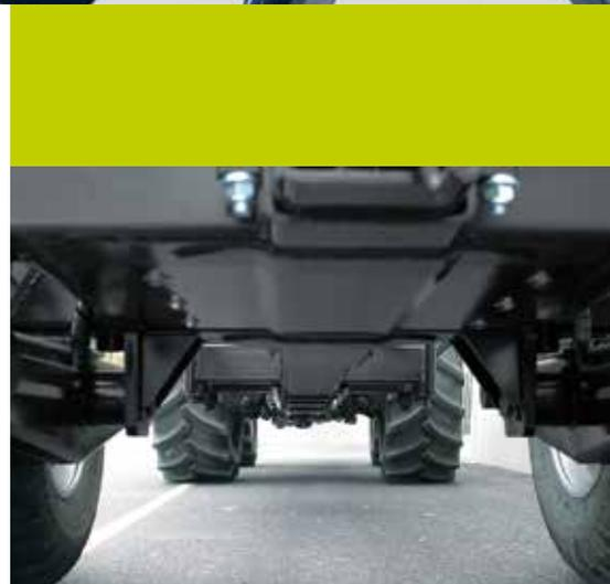
Прочная однобалочная рама и конструкция тележки моделей Junkkari P10 и P12 выдерживают нагрузку даже больших погрузочных манипуляторов.
