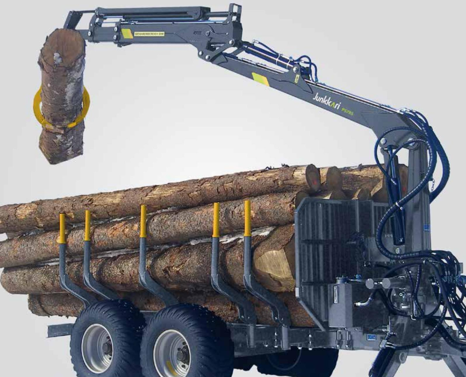
Благодаря прочности и многообразию крепежных деталей лесной прицеп P12 можно оснастить также самыми большими манипуляторами Patruuna. P12 в комбинации с погрузочными манипуляторами серии 45 или 57 обладает повышенной мощностью и отличается улучшенными характеристиками, необходимыми для работы в сложных условиях эксплуатации. Лесной прицеп P12 можно оснастить также гидравлической тягой с фрикционными роликами.
