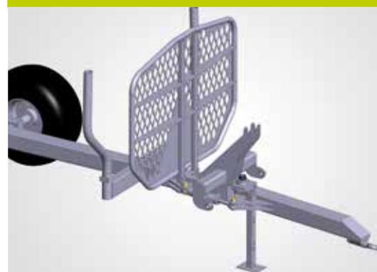
В стандартное оборудование прицепа включены одноцилиндровая система управления дышлом и стационарное дышло, что позволяет использовать с прицепом подвесные погрузочные манипуляторы Junkkari старого образца.
