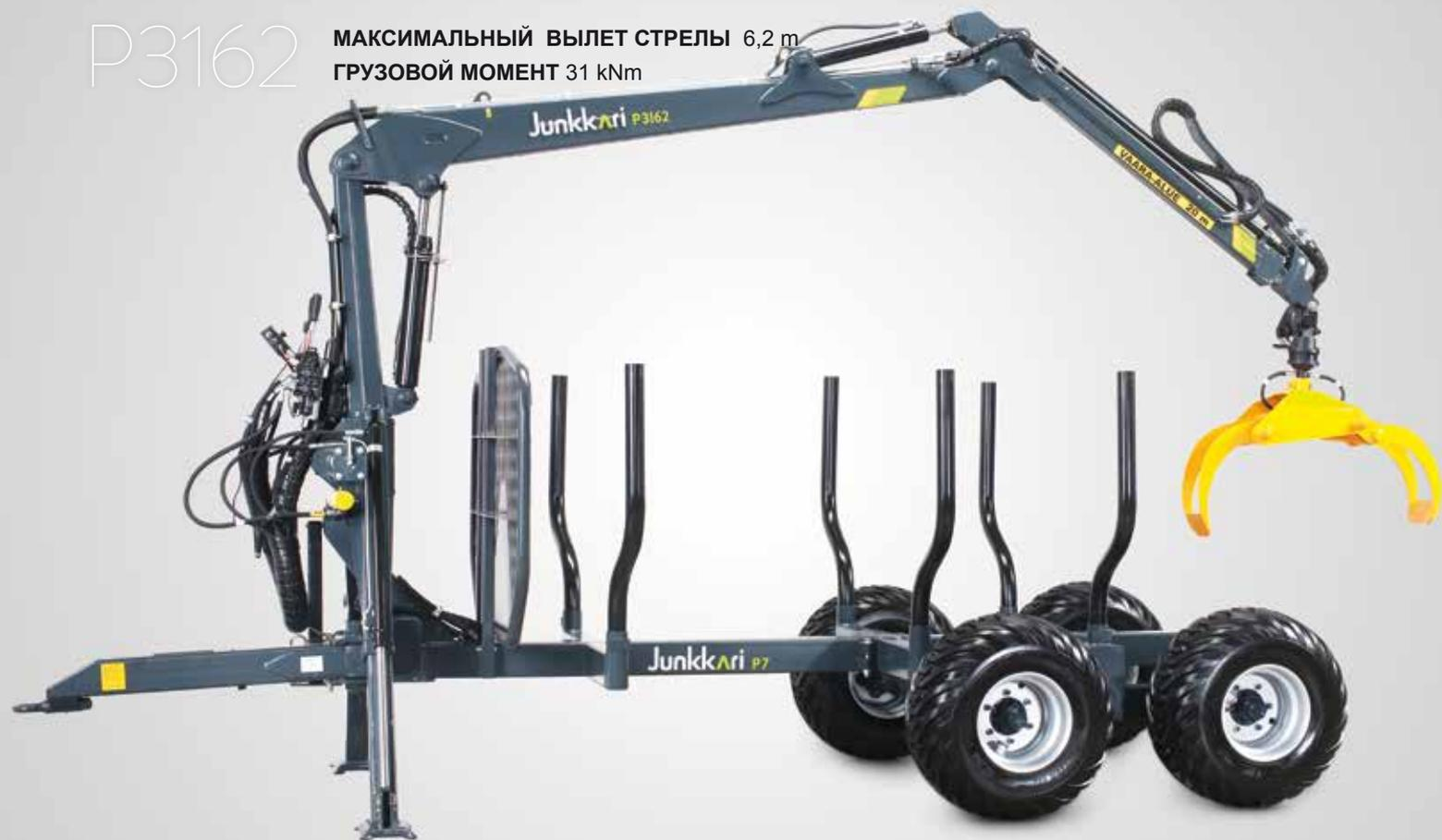
P3162 популярный манипулятор, вылет стрелы которого составляет 6,2 м, грузовой момент - 31 кNm и момент поворота - 8 кNm. Вылет стрелы увеличен за счет гидравлической выдвижной секции.
