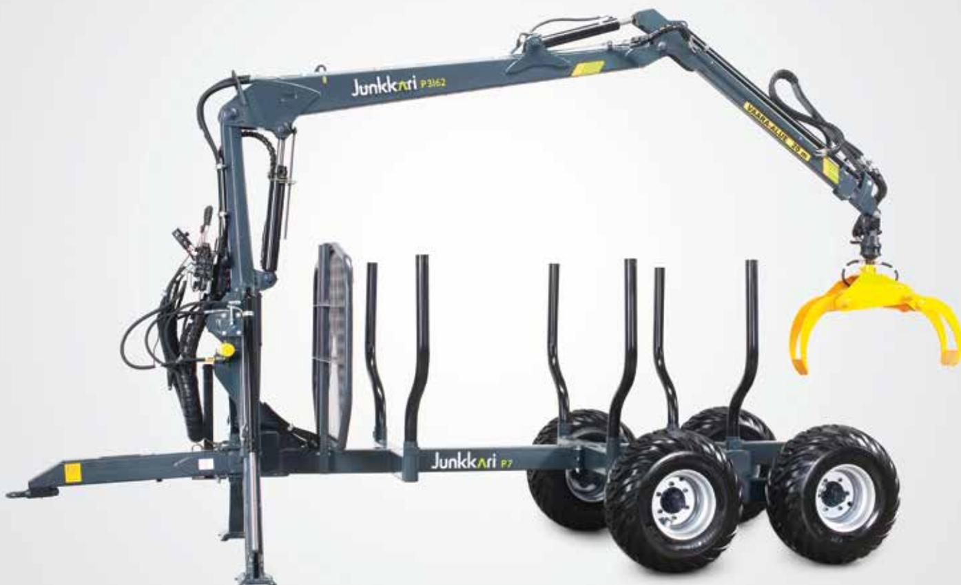
Прицеп P7 в комбинации с манипулятором серии 31 превосходно подходит для небольших лесных работ. В силу высокой маневренности это удобное решение, например, для прореживания леса. P7 отличается от больших моделей не только своими размерами, но и тем, что оснащен стационарной защитной сеткой, ограждениями, а также шарикоподшипниками и цилиндром для управления дышлом. Прицеп со стандартным оборудованием включает зажимное устройство для подвешивания погрузочного манипулятора Junkkari.
